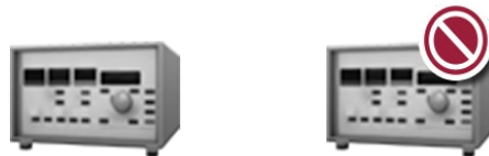
Kuva 180. Ablaatiohistorian generaattorin tilan kuvake ilmaisee yhteyttä, vasemmalla , ja että yhteyttä ei ole, oikealla
