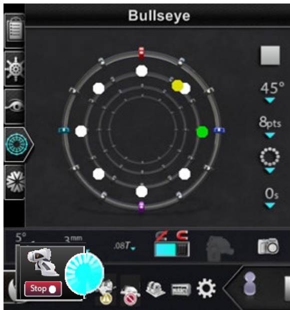
Kuva 75. Bullseye -kohdistuksen ympyrämalli sekä Automaation valintaikkuna ja Stop (Pysäytä) -painike (alavasemmalla)
