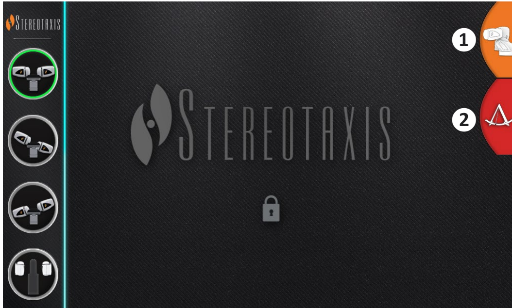
Kuva 11. UTSC-paneeli: Vasemmalla potilastason viereisen yleisohjaimen painikkeet; oikealla (1) suurenee ja näyttää 4 painiketta lisää seuraavalla näyttöruudulla ( Kuva 12 ); (2) yhdistää Navigant -näyttöön.
